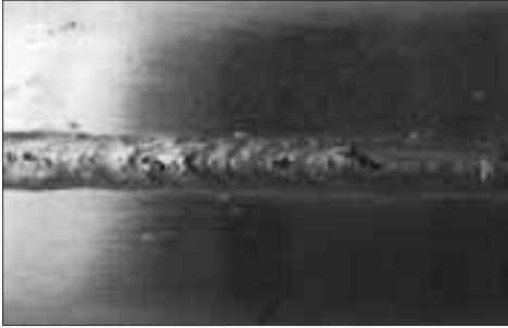
Figure 5.11. Slag islands – MIG 316L-Si
